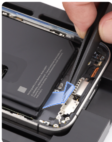
Bateriile iPhone sunt fixate folosind tipuri avansate de adezivi, concepuți să se elibereze atunci când se extind într-o anumită direcție, ceea ce permite înlocuirea bateriei.
