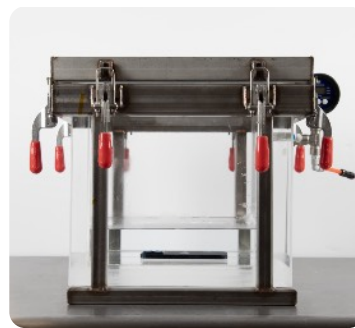
Pentru a testa protecția la scufundare în apă IPX7/8, Apple scufundă dispozitivul iPhone într-un vas presurizat pentru a simula presiunea exercitată sub apă.
