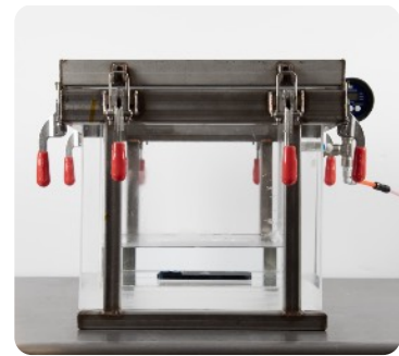
A vízbe merülés elleni védelemre vonatkozó IPX7/8 tesztekhez az Apple egy nyomástartó edénybe helyezi az iPhone-t, így szimulálja a víz alatti nyomást.
